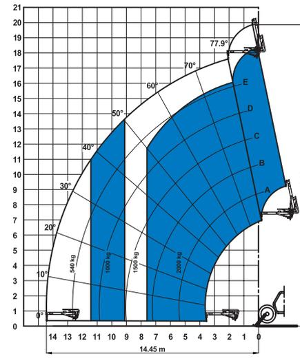
Su stabilizzatori con falcone 4 m (meccanico/idraulico)
